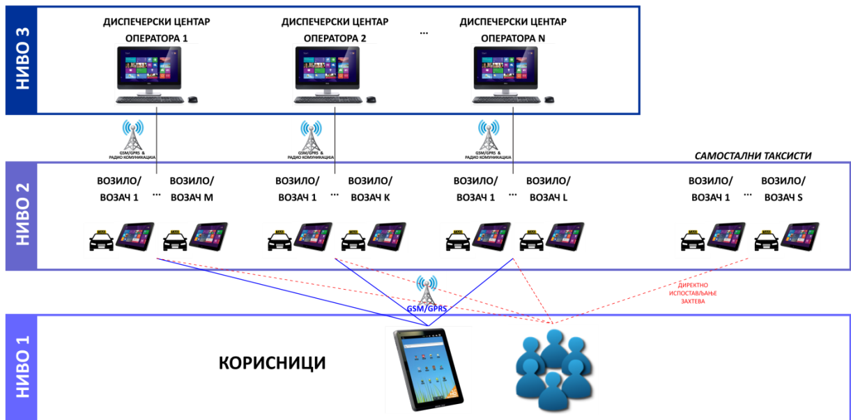
Слика 31. Хијерархијски модел постојећег система за резервисање вожњи, мониторинг и контролу функционисања такси система
