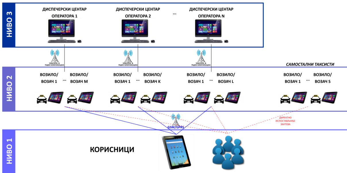
Слика 25. Хијерархијски модел постојећег система за резервисање возњи, мониторинг и контролу функционисања такси система
