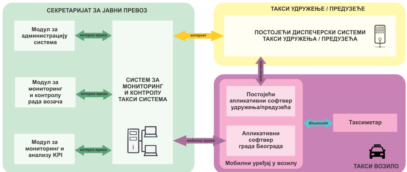
Слика 27. Архитектура система за мониторинг и контролу функционисања такси система у Београду
